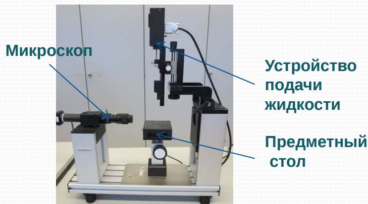
Прибор для измерения угла смачивания OCA 15EC (DataPhysics Instruments GmbH, Германия)
