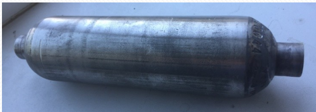
Используемый при исследованиях пробоотборник на 5 л из стали 12X18H10T с покрытием Si-VD
